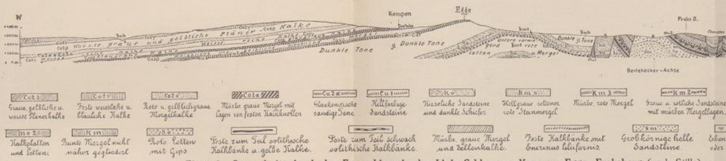
**Figur 2. Querschnitt durch das Eggegebirge in der Linie Schlangen - Kempen - Egge - Freksberg (nach Stille).**
