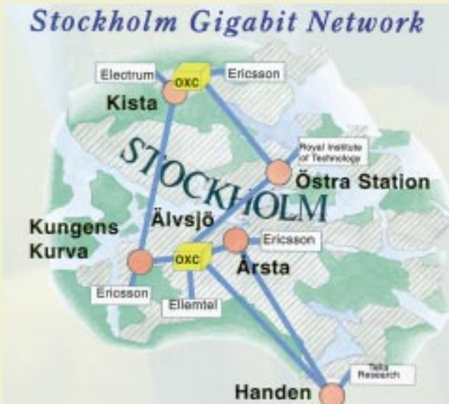
Abb. 4: Das Stockholm Gigabit Network. Ein Demonstrator, in dem in Paderborn entwickelte integriert akustooptische Bauelemente erfolgreich eingesetzt wurden.
