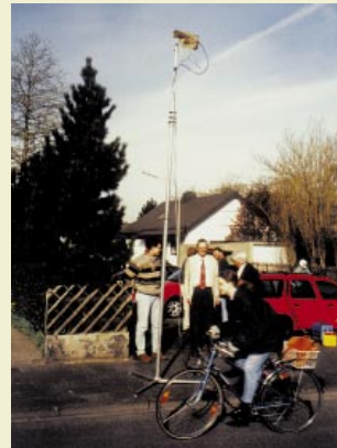
Abb. 8: Funkkanalvermessung. Empfängerantenne für 30 GHz und Signalverarbeitung sind auf dem Antennenmast montiert, der Rest des Empfängers ist im Kraftfahrzeug untergebracht. Der Sender steht woanders.
