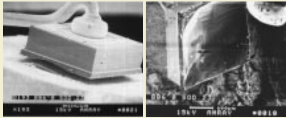
Abb. 3: Muschelbruch eines gelöteten Mikrochips (links) sowie durch thermisch induzierte Lasten abgelöster Mikrochip (rechts).
