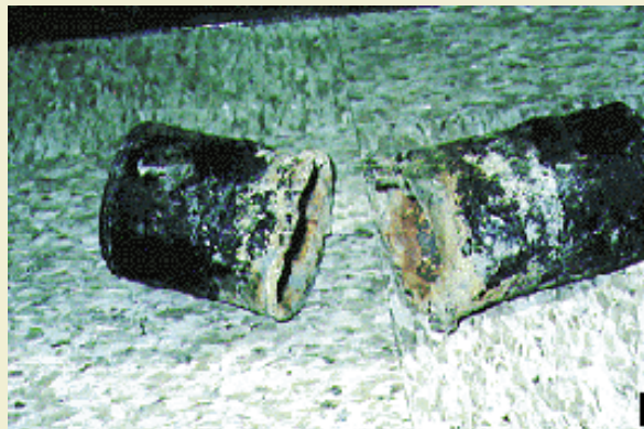
Abb. 2: Versagen entlang der Schweißnaht einer Erdgaspipeline von 8 cm Durchmesser.
