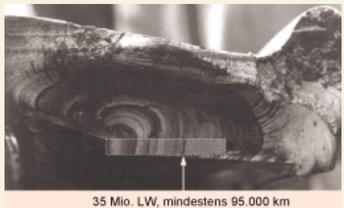
Abb. 13: Vergleich der Bruchflächen für den Radreifen und die Probe.
