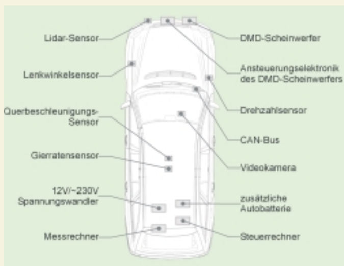
Abb. 4: Komponenten des Versuchsfahrzeugs.
