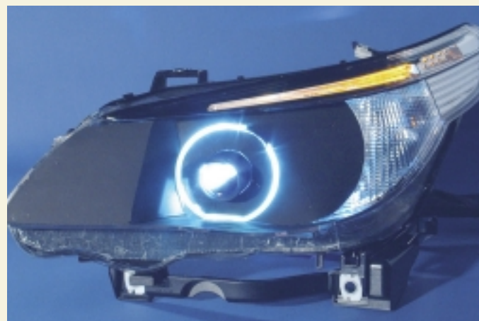
Abb. 2b: DMD-Aktiver Scheinwerfer integriert in ein Serien-Scheinwerfer-Gehäuse.
