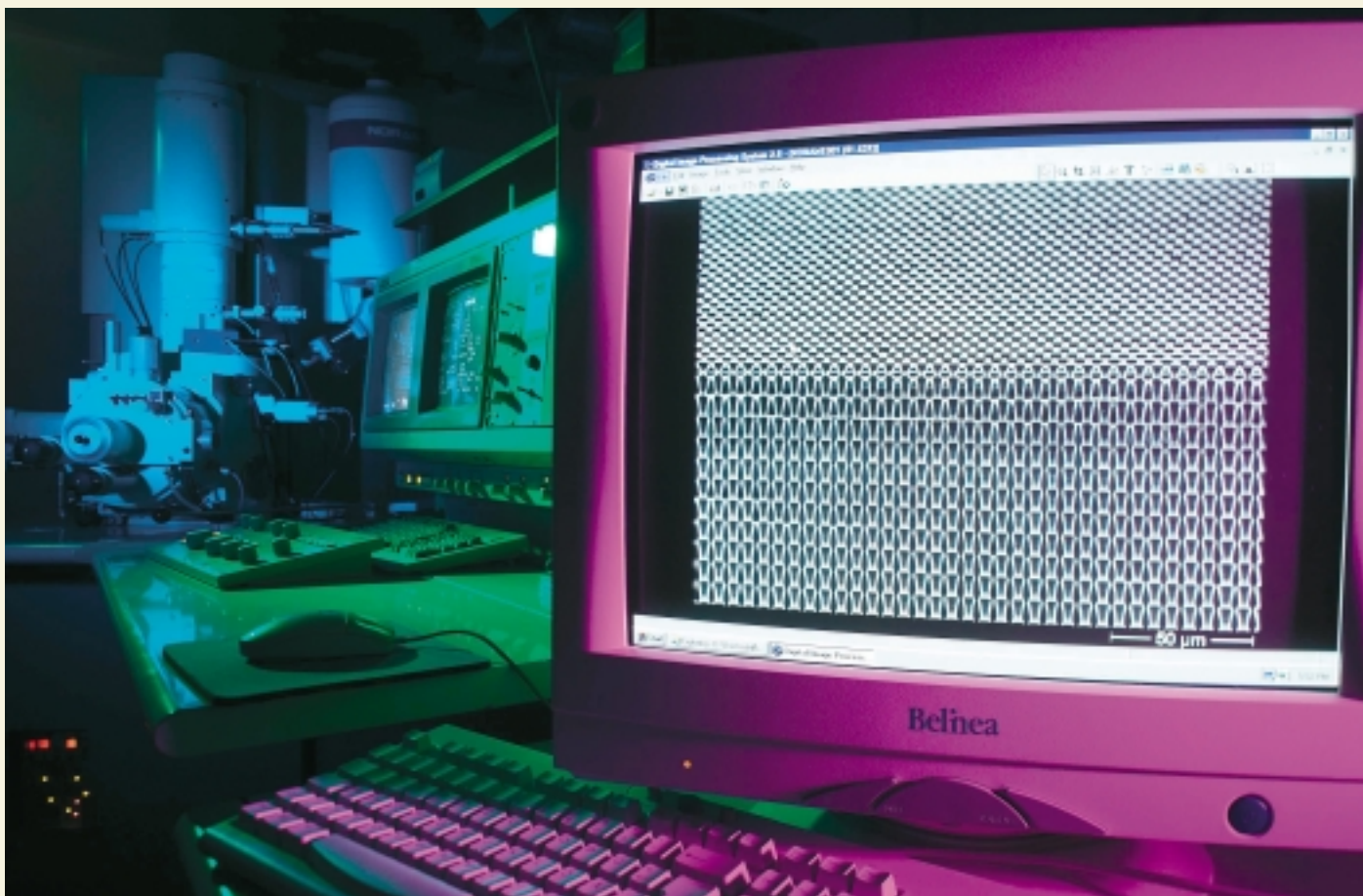
3D-photonischer Kristall aus Silizium.
