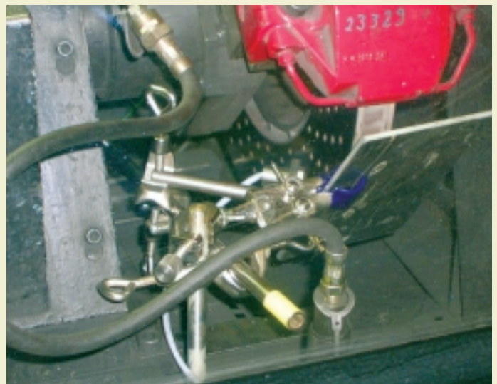
Abb. 6: Nahaufnahme des Bremsenprüfstandes mit neu lackiertem Testblech.
