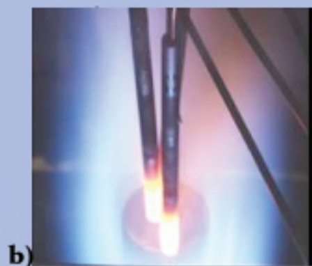
Abb. 2: a) Temperaturvergleich zwischen Simulation und Experiment bei Thermoschock b) Temperaturmessung in der Aufheizphase.
