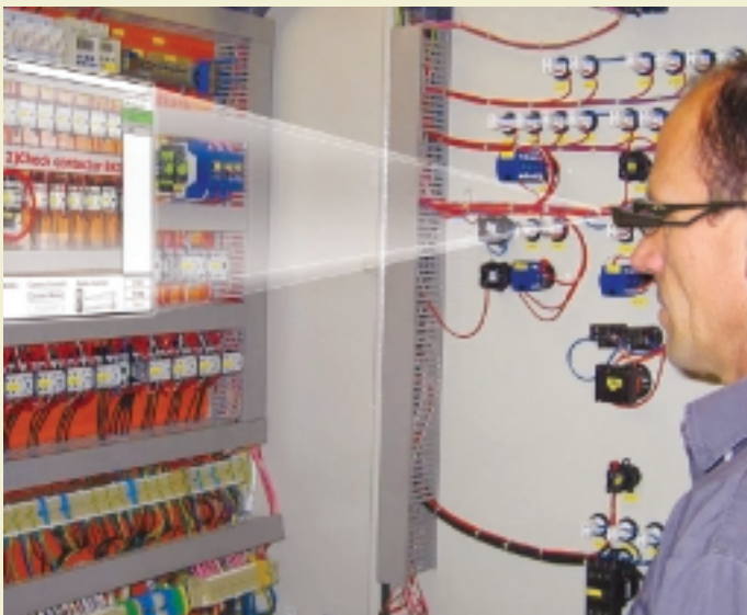
Abb. 1: Beispiel für eine AR-Anwendung: Der Techniker sieht einen virtuellen Schaltplan lagerichtig über der realen Schaltung.
