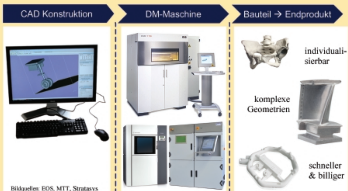
Abb. 1: Grundprinzip der direkten Fertigung von der CAD-Zeichnung unmittelbar zum fertigen Endprodukt.
