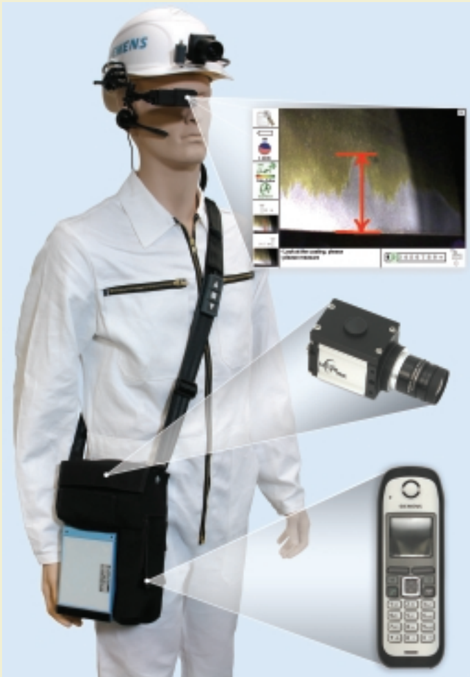
Abb. 6: Das Mobilsystem mit dem tragbaren Computersystem, Telefon und zwei Kameras. Als Monitor dient ein industrietaugliches Head-Mounted-Display, das am Helm befestigt ist.
