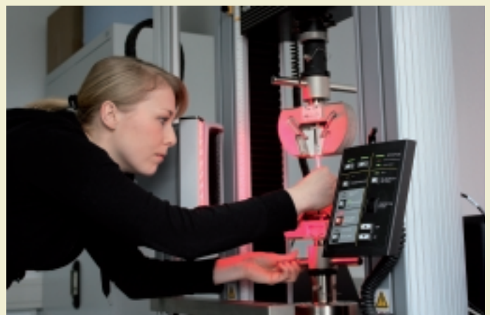
Abb. 7: Ermittlung der Zugfestigkeit von gesinterten Probenkörpern.
