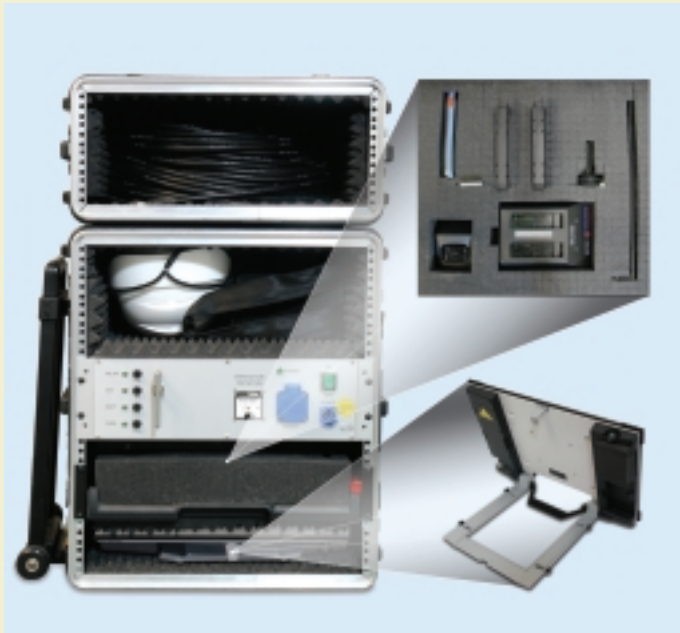
Abb. 8: Infrastruktursystem, über das vor Ort die benötigten Kommunikationskanäle bereitgestellt werden.
