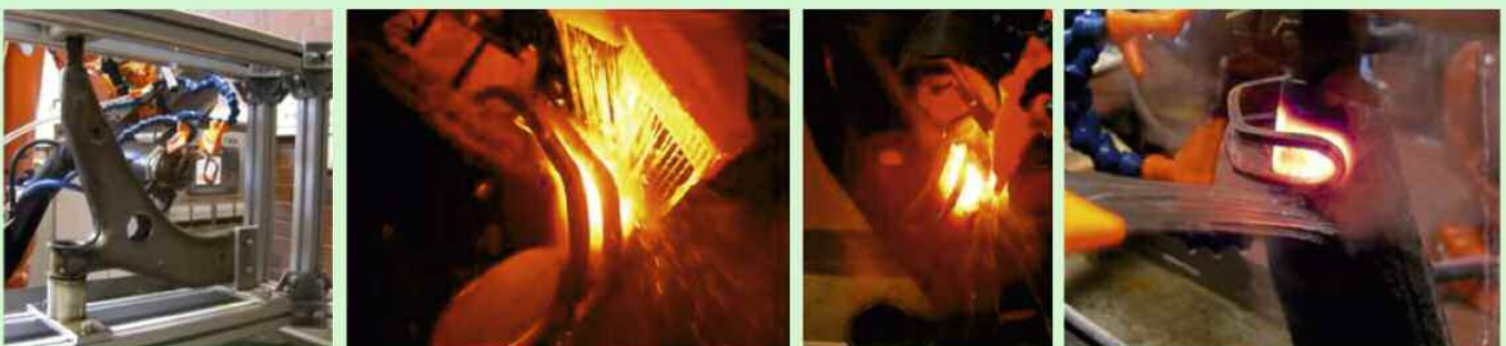
Abb. 4: Partielle induktive Härtung eines Querlenkers: Der Induktor erwärmt die Struktur in definierten Bereichen. Durch das anschließende Abschrecken wird der Werkstoff gehärtet.
