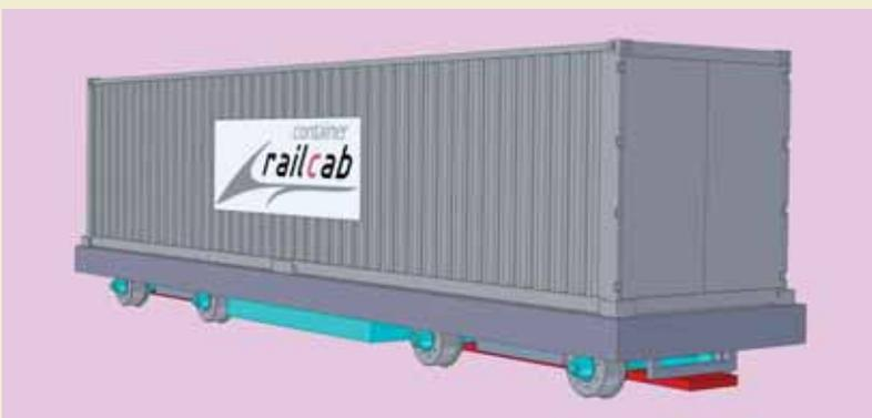
Abb. 1: ContainerRailCab mit 40 ft.-Container.
