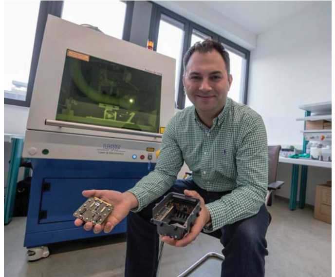
Die Funktionen auf der sperrigen Leiterplatte (links) werden im Fraunhofer IEM direkt ins Gehäuse des Gerätes (rechts) gebracht. Christoph Jürgehake arbeitet an der Weiterentwicklung der Technologie (© David Gense).
