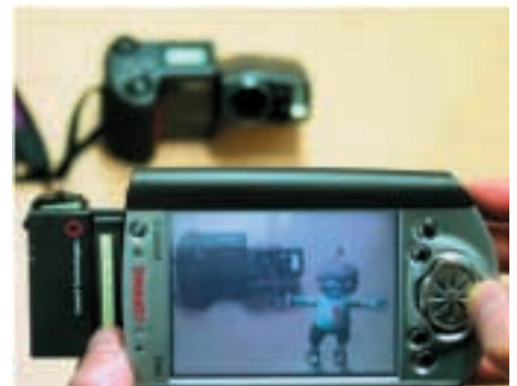
Prototyp des AR-PDA: Ein virtueller Charakter erläutert die Funktionsweise der auf dem Tisch liegenden digitalen Kamera
