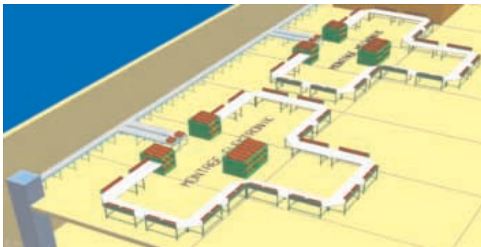
Layoutskizze eines Fertigungsbereichs.
