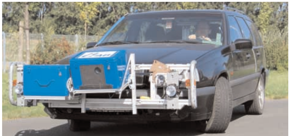
Das von Jacek Roslak und Rainer Kauschke entwickelte System zur blendungsfreien Ausleuchtung des Verkehrsraumes, basierend auf einem aktiven DMD-Scheinwerfer (Digital Micromirror Device) in Kombination mit einem LIDAR-Sensor (Light Detection and Ranging)
