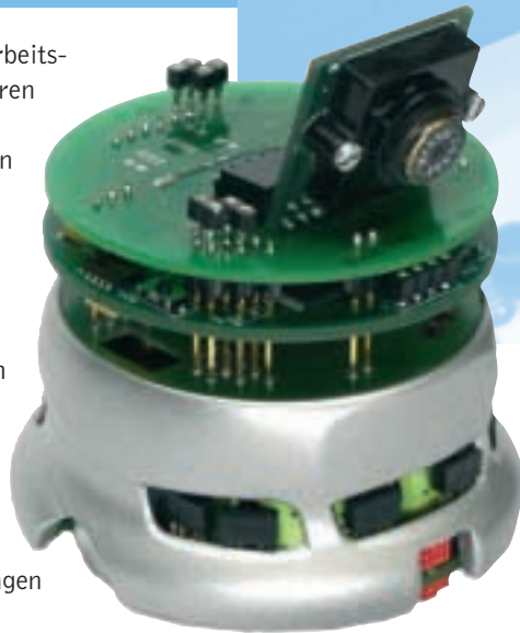
Mobiler Miniaturroboter mit FPGA-basiertem Kameramodul [Quelle: Prof. U. Rückert, Heinz Nixdorf Institut]
