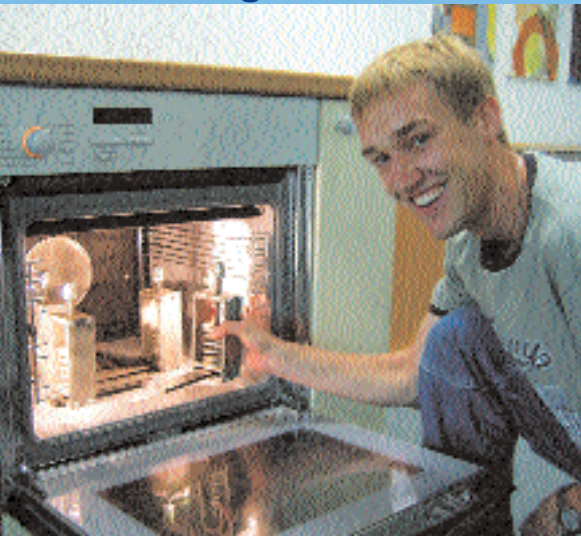
„Fertig gebacken“ – ein Student entnimmt die Probe samt Vorspanneinrichtung aus dem Ofen nach heißhärtender Klebung
