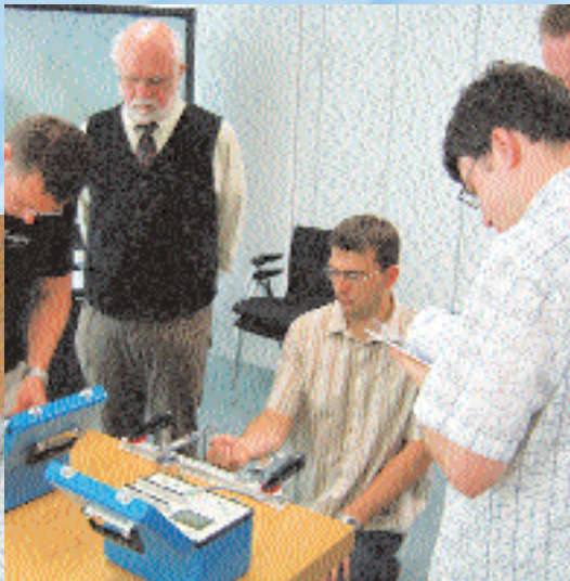
Wie konfiguriere ich den Messverstärker? – „Feuerprobe“ für die selbst applizierten und verschalteten Dehnungsmessstreifen
