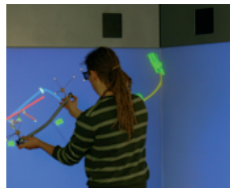
Innovatives Eingabegerät für die interaktive Verlegung von Schläuchen und Kabeln in einer virtuellen Umgebung (FH Düsseldorf/flexIlution GmbH)
