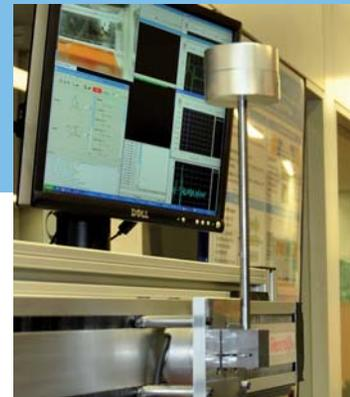
Das „Inverse Pendel“ ist ein Demonstrationsobjekt. Ein Regler schwingt das Pendel auf, bis es in einer bestimmten Position balanciert.
