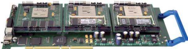
Demonstrator des weltraumgeeigneten Informationsverarbeitungsmoduls (DRPM) auf der Basis des in der Fachgruppe Schaltungstechnik entwickelten Rapid-Prototyping-Systems RAPTOR-X64
