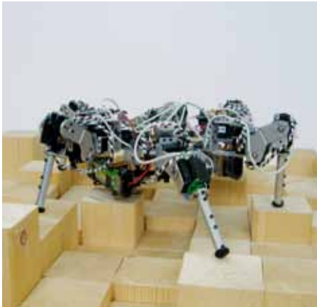
Sechsheiniger Roboter OSCAR (Organic Self Configuring and Adapting Robot) mit den Self-X-Eigenschaften selbst-heilend, selbst-organisierend und selbst-optimierend (Quelle: Institute of Computer Engineering, Universität Lübeck)
