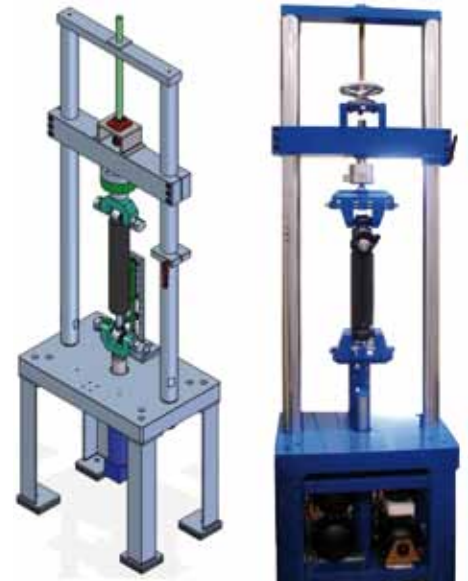
Bild 2: Federbeinprüfstand mit eingespanntem semiaktivem Dämpfer
