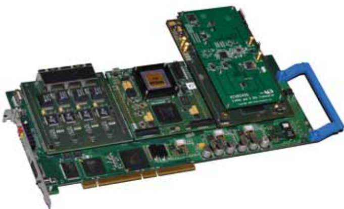
Mithilfe des CoreVA-Prozessors wurde auf Basis des RAPTOR-Prototyping-Systems eine vollständige Software-defined-Radio-Lösung aufgebaut.
