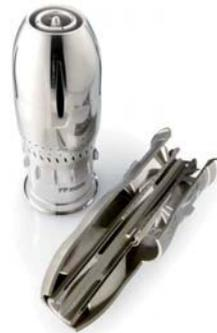
Fuel Injection Swirler, Morris Technologies, per Direktem Metal-Laser-Sinter-Verfahren (DMLS) hergestellt, hochkomplexes Teil, in einem Stück gebaut, erhebliche Reduzierung bei Herstellung sechs auf zwei Wochen, erhebliche Kostenreduzierung von minimum 50%, erhöhte Festigkeit.
