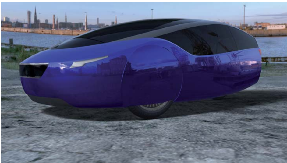
Der im Dreirad Design entworfene Urbee ist ein Plugin-Hybrid, der mit einem sehr sparsamen Ethanol-Gemisch (etwa 1,2 Liter/100 km bei 7 PS und 64 km/h Höchstgeschwindigkeit), aber auch mittels aufladbarer Batterie betrieben werden kann. Alle Teile der Karosserie, auch die Glas-Panels wurden mittels additiver Fertigungsverfahren produziert. (Bildquelle: Statays Inc.)
