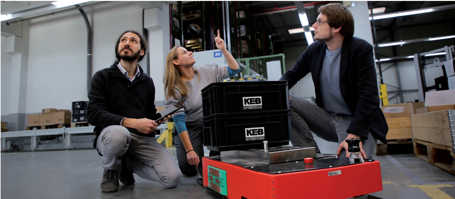
Die Navigation des Transportsystems erfolgt über die Deckenbeleuchtung. Dr. Alexandre Bousaid, Bianca Miene (beide OSRAM) und Tommy Falkowski (Fraunhofer IEM) diskutieren die Technologie.
