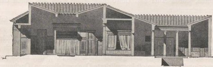
Abb. 18. Längenschnitt des Hauses bei der Porta Marina.
