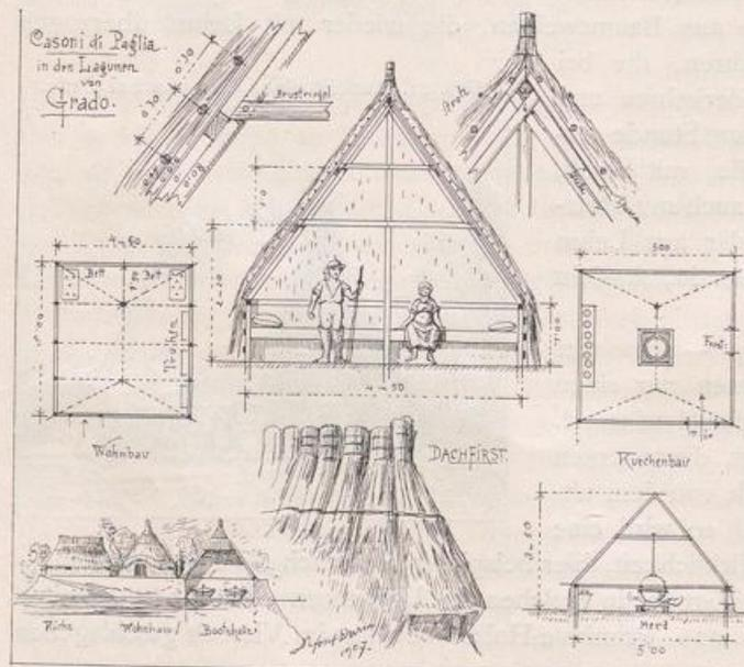
9 cm dicke Sparren bei 35 cm Legweite aufgesattelt sind, die wieder 30 cm auseinander liegende 4 cm starke Lattenstäbe tragen, die Strohbüschel aufnehmen und außen durch Äste zusammengefaßt sind (vgl. Abb. 23).
