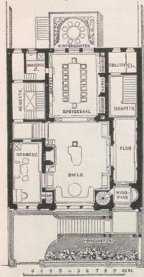
Abb. 78b. Idealentwurf für ein Dreifensterhaus von EBE und BENDA (Untergeschöß).
