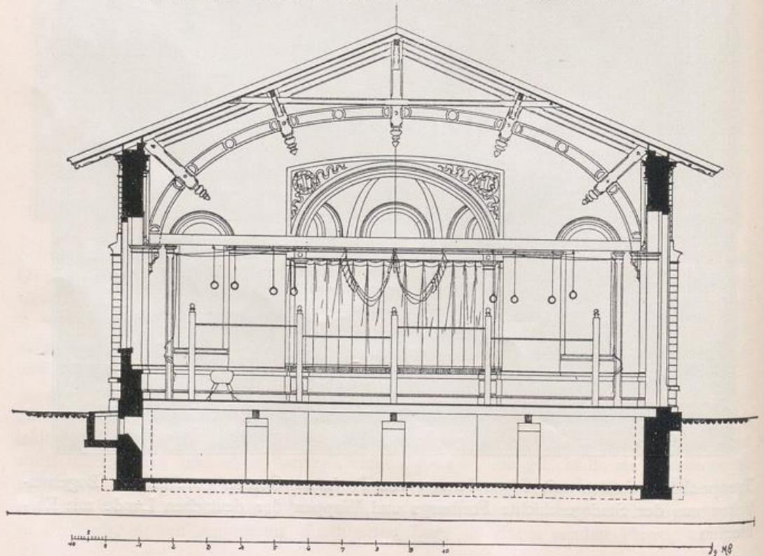
Als vorbildliches Beispiel einer Turnhalle kann die nach Abb. 203a u. b vom † Oberbaurat H. LANG in Karlsruhe ausgeführte bezeichnet werden. Die Abmessungen sind richtig getroffen, der offene Dachstuhl mit seiner Bohlenkonstruktion wirkt gut, die Konstruktion des Fußbodens ist die einzig richtige — fest und federkräftig.
