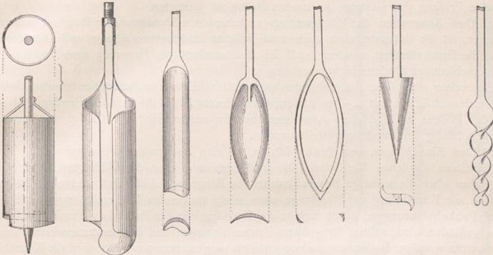
Demselben Zweck dienen in weichem Gestein der mit S-förmigem Querschnitt und zwei Schneiden versehene Trepanierbohrer (Abb. 11), sowie die amerikanische Zunge (Abb. 12), deren mehrfache Schraubenwindungen beim Emporheben des Bohrers etwas Erde mit herausbringen.
