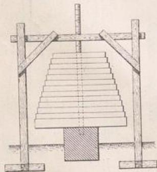
Alsdann kann aus der Größe der Belastung und derjenigen der Druckfläche die Tragfähigkeit und aus dieser die zulässige Belastung des Baugrunds für die Flächeneinheit berechnet werden (vgl. § 4).
