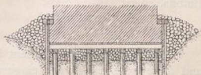
Abb. 155. Pfahlrost mit Spundwandumschließung.
