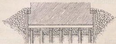
Abb. 155. Pfahlrost mit Spundwandumschließung.
