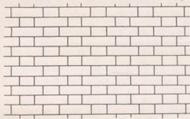
Abb. 51. Polnischer oder gotischer Verband.
