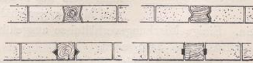
Abb. 71 bis 74. Anschluß der Backsteine an Holzwerk.
