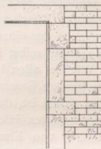
Abb. 31. Höhe der Werksteine neben Backsteingemäuer.
