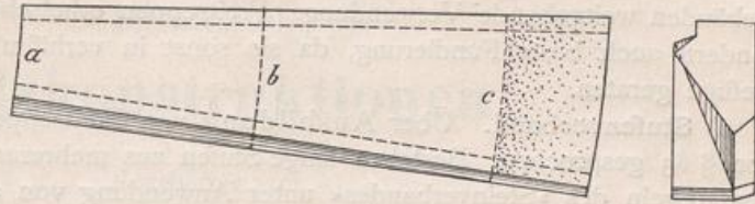
Abb. 469 bis 473. Treppenstufen mit windschiefen Falzen.
