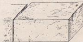
Abb. 32. Stoßfläche der Werksteine.
