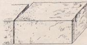
Abb. 32. Stoßfläche der Werksteine.
