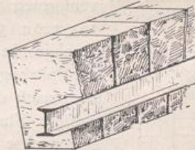
Abb. 200. Scheitrechter Bogen mit eiserner Hilfskonstruktion.
