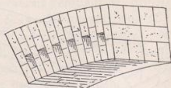
Abb. 295. Eingreifen leichter Gewölbe mittels »Zahnung«.
