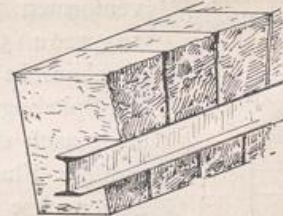
Abb. 200. Scheitrechter Bogen mit eiserner Hilfskonstruktion.
