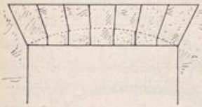
Abb. 196. Wölbungsfugen zur Vermeidung spitzer Winkel an den Steinen.
