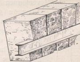
Abb. 200. Scheitrechter Bogen mit eiserner Hilfskonstruktion.
