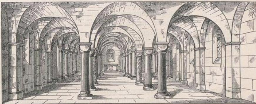
Das Kreuzgewölbe besitzt verhältnismäßig bedeutende Festigkeit selbst bei großen Spannweiten. Aus dem gleichen Grunde, aus dem sich bei sphärischen Großkonstruk-
