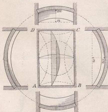
»Böhmisches Gewölbe«, in anderen wieder mit demjenigen »Böhmisches Kappengewölbe« belegt. Meistens versteht man unter letzteren Bezeichnungen jedoch ellipsoidische Gewölbe entsprechend Abb. 359, bei denen die Schildbogen von gleicher Höhe sind.
