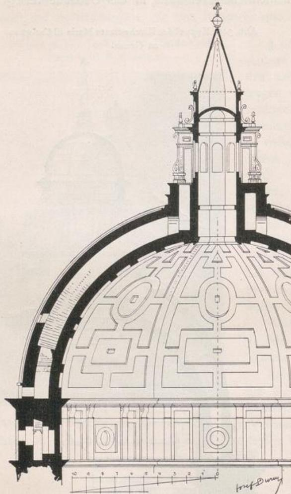
Abb. 350 Schubrichtung der Haupt-, sowie der Schutzkuppel.
