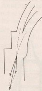
genommen; als man aber zur Ausführung schritt, wurden doch die hier in schwarzer Weise dargestellten parabolischen Kuppelformen gewählt, wobei die äußere Kuppel eine noch steilere Form als die innere erhielt. In Abb. 348 nähert sich das Kuppelpaar mehr der Kugelwölbung und in Abb. 349 ist diese bei beiden Gewölben erreicht.
