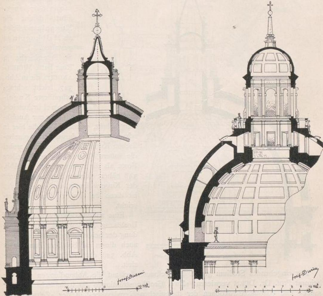
wurde (Abb. 350), was natürlich von Vorteil für die Anlage der Widerlagsmauern war. Am Scheitel der Gewölbe wurde statt zweier Lichtringe jetzt eine Lichttrommel ausgeführt, gegen die sich beide Gewölbe lehnten; auf diese wurde eine Laterne gebaut, deren Last — entsprechend dem Schlußsatz in § 44 — auf die Standfestigkeit der Gewölbe günstig wirkt.
