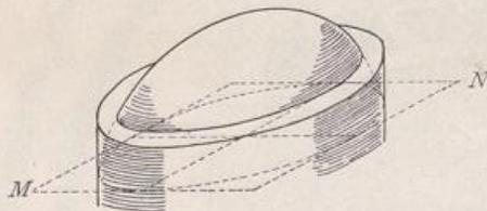
Abb. 359. Ellipsoidisches Gewölbe.
