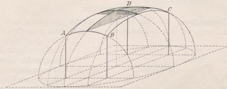
ergibt sich bei Überwölbung eines elliptischen Raumes mit einem halben Ellipsoid ein Ellipsoidgewölbe (desgleichen bei einem vieleckigen Raum unter Anordnung von Pendentifs). Das Ellipsoidgewölbe ist entweder ein überhöhtes (s. Abb. 158, S. 107) oder ein gedrücktes (s. Abb. 157).
