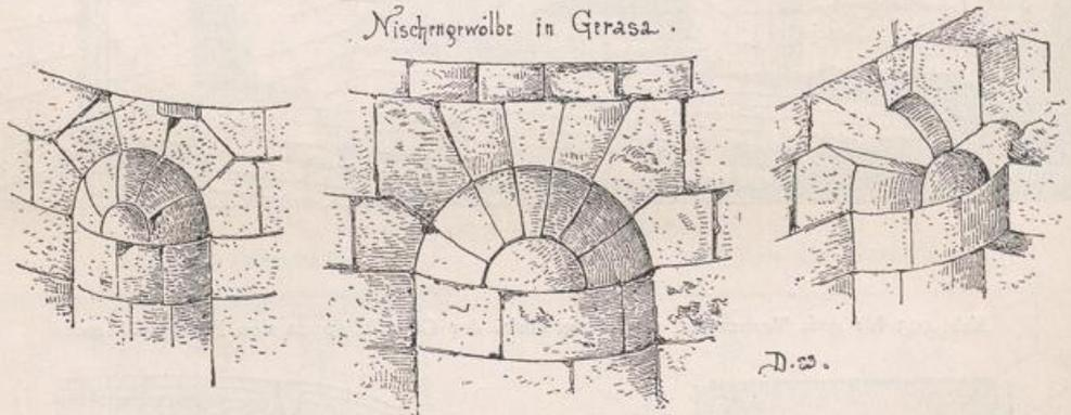
Abb. 414. Unterstützung von Gewölbewangen durch Überkragung.
