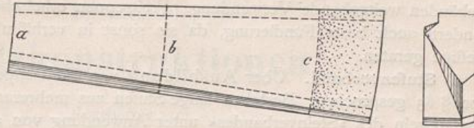
Abb. 469 bis 473. Treppenstufen mit windschiefen Falzen.
