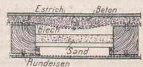
Abb. 173. Blechabdeckung der Balken.
