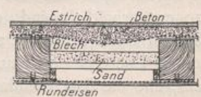
Abb. 173. Blechabdeckung der Balken.
