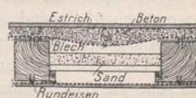
Rabitzgewebe feuersicher zu ummanteln. Dabei wird das Tonziegelgewebe in einem Abstand um die Balken gezogen, den man durch aufnageln von Latten auf die Balken
