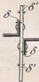
Abb. 167. Anschlu eines Fachwerkstabes.
