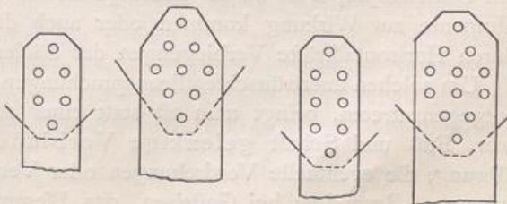
7. Der Anschluß von Flacheisen an Knotenbleche soll möglichst mittels zweischnittiger Nietverbindungen mit zentrischer Kraftübertragung vorgenommen werden. Hat man ein Flacheisen an ein Knotenblech anzuschließen, so wähle man deshalb eine zweischnittige Verlaschung (Abb. 264). Zweischnittige Anschlüsse lassen sich auch erzielen,
