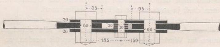
**3. Vernietete Knotenpunkte.** Bei der Konstruktion der vernieteten Knotenpunkte, also solcher Knotenpunkte, bei denen jeder Stab durch Niete angeschlossen ist, sind folgende Regeln zu beachten:
