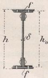
Abb. 381. Angen herte Berechnung der Querschnittsabmessungen der Blechtr ger.
