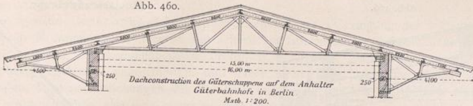
Abb. 460 bis 462. Eiserne Binder für Balkendächer.
