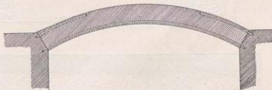
Die MONIER-Bauweise findet bei den Gewölben dieselbe Anwendung, wie bei den Platten, und zwar erhalten Gewölbe von geringer Spannweite für Decken und dergl. nur eine Einlage an der inneren Leibung. Für größere Gewölbe dagegen wendet man außer dieser noch eine teilweise Armierung im Rücken an, die sich bei sehr veränder-
