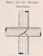
Abb. 113. Verbindung der
