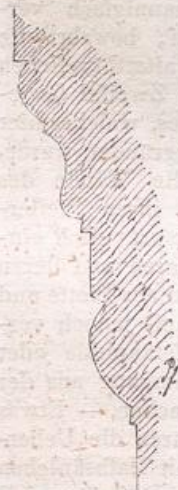
Profil des Kämpfergesimses am Portal.
