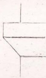
Kämpfergesims der alten Schiffpfeiler.
