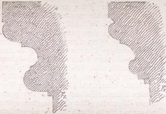
Deckglieder an Säulenkapitälern und Pfeilern im Schiff der Kirche.
