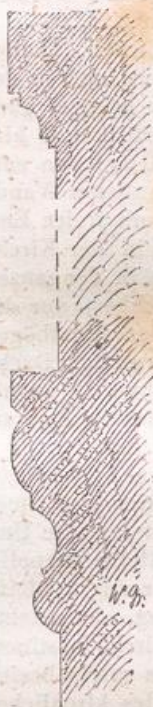
Krönungsgesims und Basament der Brüstung.
