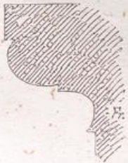
Kämpfergesims des Mittelpfeilers der Vorhalle.
