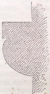
Deckgesims der Pfeiler in der Loge.
