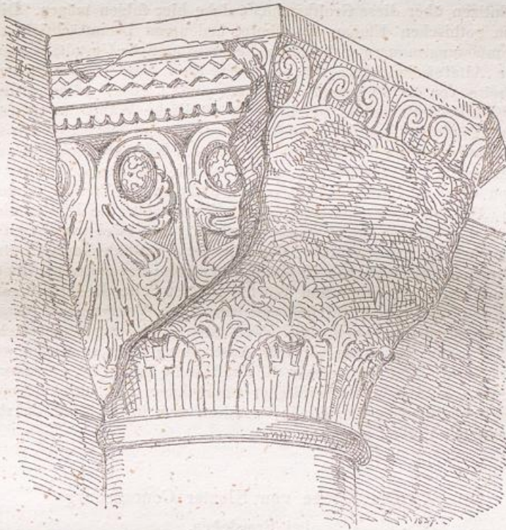
Kapital der Schiffsäulen mit Resten der späteren Umkleidung und der wieder hervortretenden ursprünglichen Arbeit.
