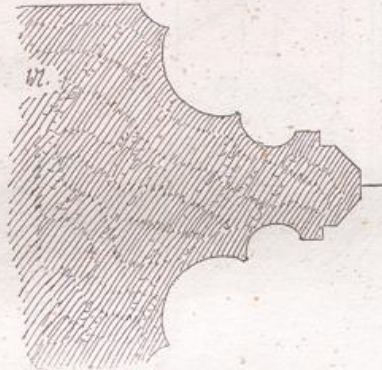
Fensterprofil im nördlichen Seitenschiff.
