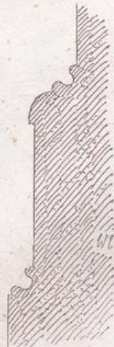
Basament der nördlichen Schiffpfeiler.
