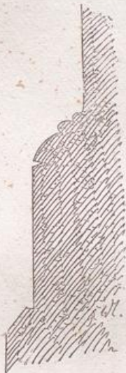
Basament der südlichen Schiffpfeiler.
