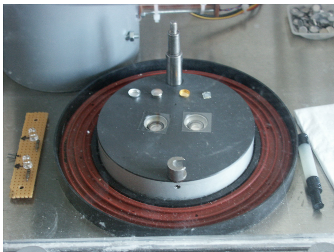
Abb. A4.6: DSC-Ofen (links Probe – rechts Referenz) mit verschiedenen Pfännchenarten: -Alupfännchen, offen -Alupfännchen, geschlossen -Goldpfännchen -Mikroglaszelle links ausgebaute LED-Beleuchtungsvorrichtung
